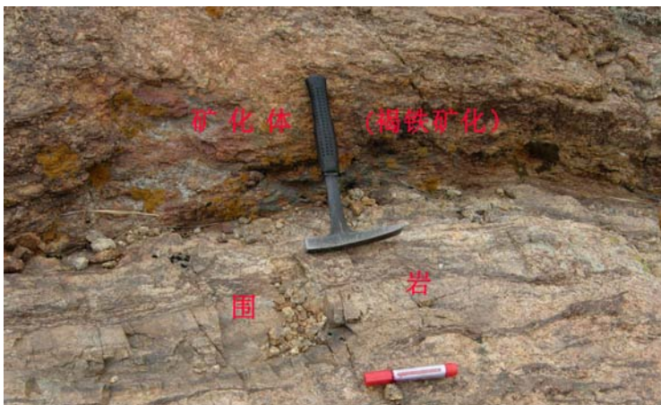
图7 矿化体褐铁矿化蚀变标志与围岩分界
